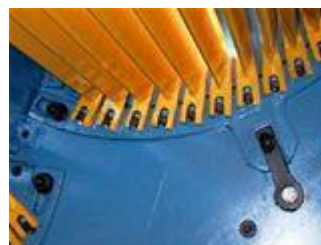
Колосниковая решётка имеет регулируемый угол наклона, благодаря чему возможно изменение интенсивности чистящего воздействия.
