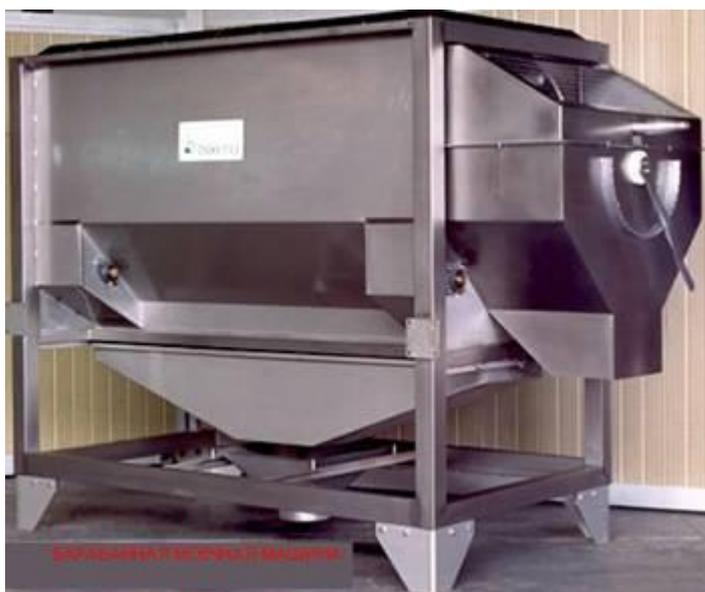
Рисунок 16 – Барабанная моечная машина
