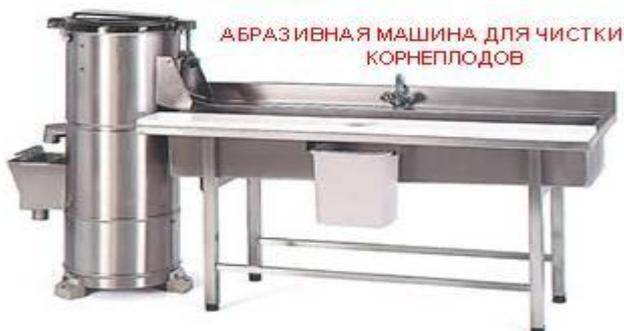
**Рисунок 20 – Абразивная машина для чистки корнеплодов**
