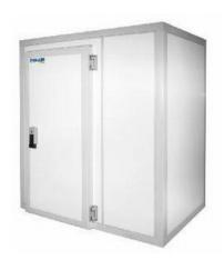
Панели состоят из слоя заливной теплоизоляции (пенополиуретана), покрытого с двух сторон листовым металлом. В производстве стеновых и потолочных панелей используется горячеоцинкованный стальной лист толщиной 0,5 мм с полимерным покрытием. Для половых панелей применяется горячеоцинкованный стальной лист толщиной 1,2 мм.
